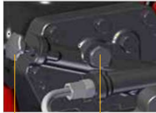
Válvula de aislamiento La tubería de un remolque de volteo se conecta en este punto
