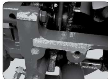
Ilustración 1.3 Número de serie del tractor en el lado derecho del soporte del eje delantero
