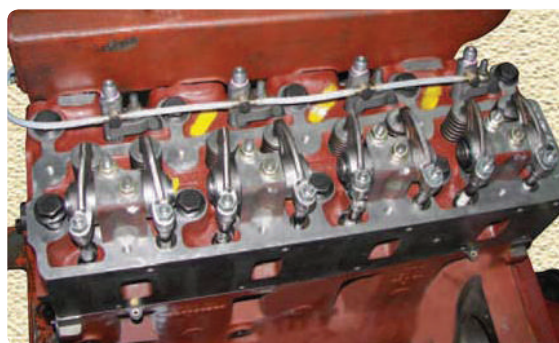
Verificación de la holgura de las válvulas
